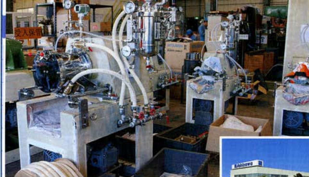
ナノ単位まで材料を粉碎する機械「スターミル」を製造するアシザワ・ファインテック。化粧品や印刷塗料をつくる際に必要とされている
